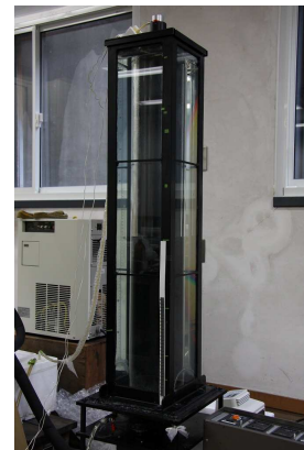
図 3. 温度差のある回転 2 重円筒実験装置。
