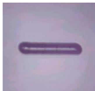
図1 シリンダー状レンズ (レンズ長さ2mm, 幅400 \mu m)
