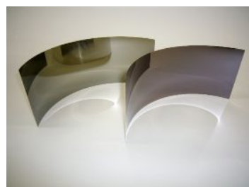
図5 硬X線望遠鏡用Pt/C多層膜非球面レプリカスーパーミラー反射鏡
