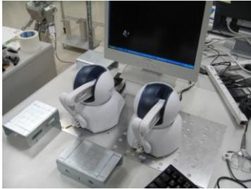
図4 同時に操作できる2本のPhantom Omni.
