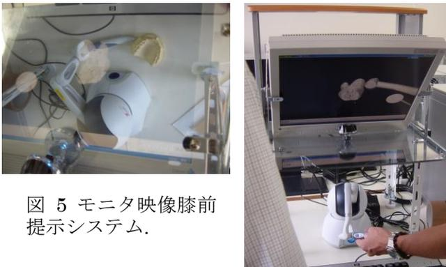
図5 モニタ映像膝前提示システム.
