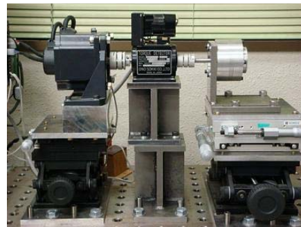
図6 モータの鉄損測定装置
