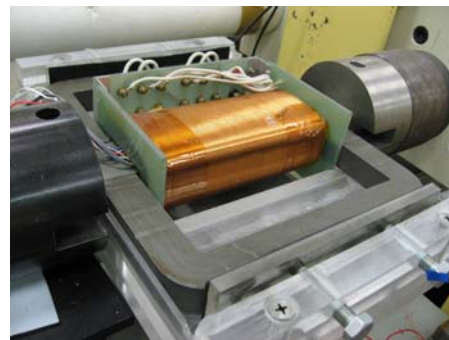
図1 応力印加時の特性測定装置
