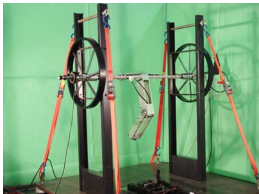
図 2 しなりのある鉄棒の検証実験装置
