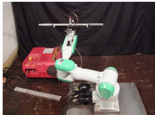
図1 デビルスティックの検証実験装置
