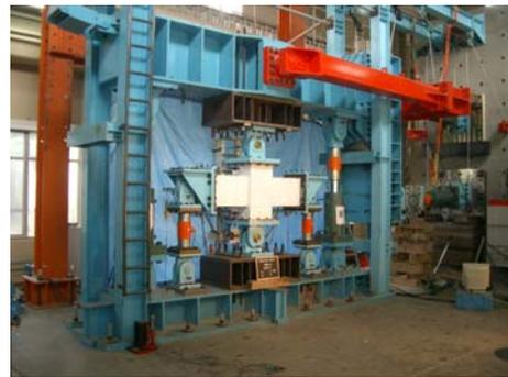
写真2 柱梁接合部の実験装置
