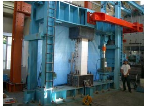
写真1 柱の実験装置
