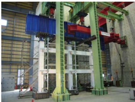
写真3 CES架構の実験装置
