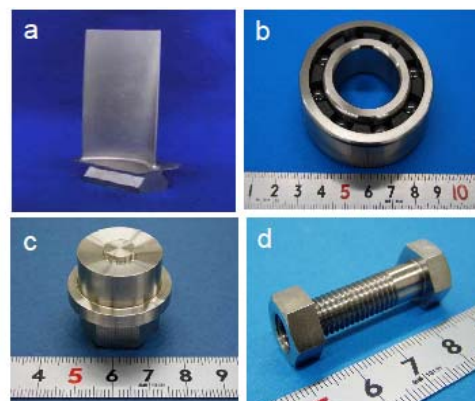
図4 Ni基超合金製試作品。(a)ジェット・エンジン用タービン・ブレード、(b)超耐熱・耐食ボールベアリング、(c)高融点硬質鉄系用摩擦攪拌(FSW)接合ツール、(d)超耐熱・耐食ボルト・ナット
