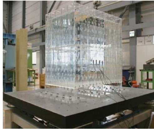
振動台上の亚克力製防とうタンク構造モデル
