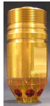
図1 開発したHQサイズ対応円錐ビット（左）とストレインセル（右）
