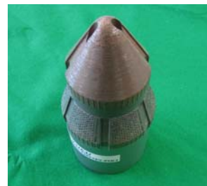
図1 開発したHQサイズ対応円錐ビット（左）とストレインセル（右）
