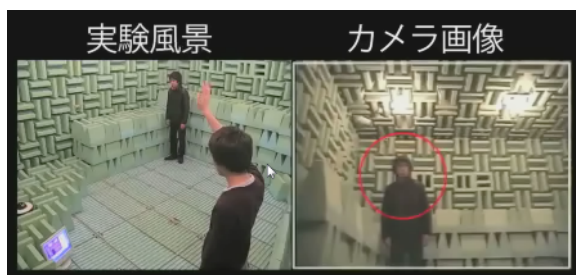
図5 ビデオ映像による人間の検出と3本のマイクロホンを利用した音源抽出を連携させた実験風景（ビデオ）の例：画角外の音源の追跡をさせたデモ
