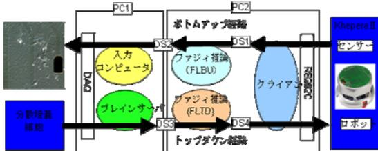
ケペラから培養細胞へのボトムアップ処理では、Client がケペラの IR センサ情報を読み取り、データソケット DS1 を経由して、ファジィ推論ユニット (FLBU) により電流刺激の回数と刺激電極の位置を制御する。その後、Input Com と DAQ を介して 2 点の刺激電極を決定して、海馬培養神経細胞を電気刺激する。トップダウン処理では、DAQ を介して BrainServer が検出時間幅に出現した培養神経細胞の活動電位の頻度を DS3 に書き込む。ファジィ推論ユニット (FLTD) が活動頻度からケペラロボットの左右のアクチュエータの -20~+20 の速度を推論して、ケペラを制御する。なお、ファジィ推論には簡易型ファジィ推論を用い、8 入力 1 出力で、Low と High の 2 種類ファジィラベルによる 512 個のルールを構成した (次図参照)。
