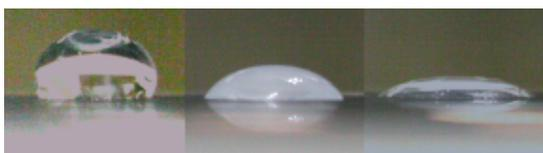
写真2 高撥水性印刷スライドガラスを用いた食塩水滴表面積の制御。
