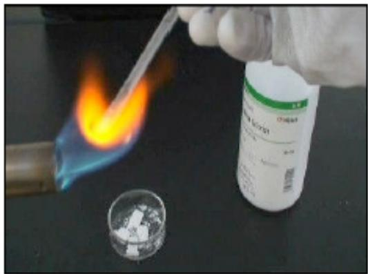
写真7 写真6の薄片の表面に生成した物質を炎にかざすとナトリウムの炎色反応が確認できた。
