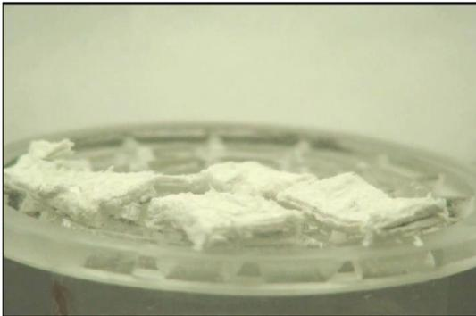
写真6 塩素ガスと7時間接触させた金属ナトリウム薄片（この様子は5分毎の静止画と撮影してから繋げて動画教材化した。パイが膨らむように塩化ナトリウムが生成する様子がわかる）。
