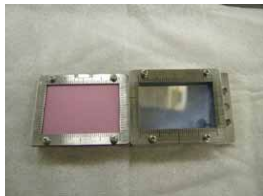
図 1 チェレンコフ発光部。左はビームプロファイルモニター用の厚さ 0.1mm の蛍光セラミックで、ビーム軸に対して 45° に取付けている。右は 55.8° の角度で取り付けられた疎水性エアロジェルで、背面からアルミミラーでサポートされている。
