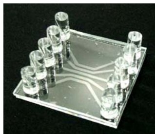
(図3 試作した5 cm 5 cm PDMA-ガラスハイブリッド型マイクロチャンネルチップ)
