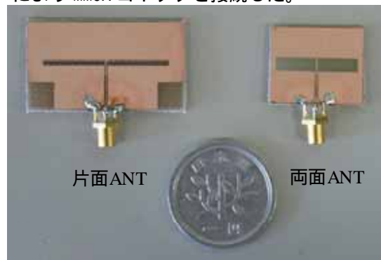
図7 試作した片面指向性アンテナと両面指向性アンテナ
