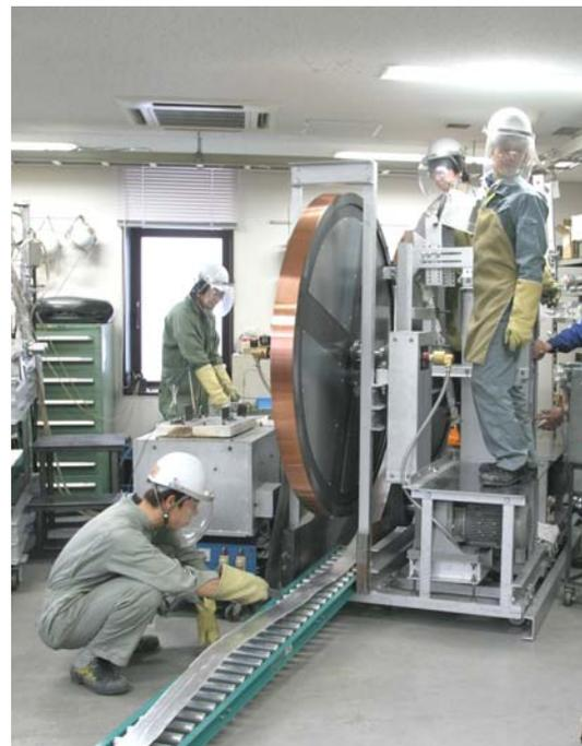
(c) 薄板の casting 風景 (60m/min)
