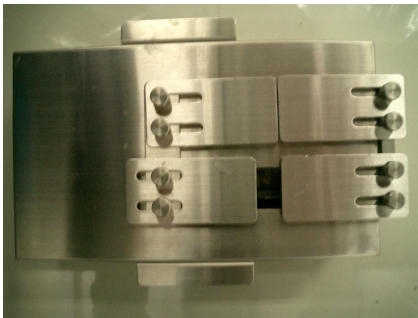
図 1:(上図はシールド用のケージ、窓の開いている部分だけ照射が行われる)
