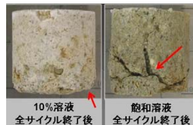
図10 円筒型石材による凍結融解繰り返し実験の結果(赤矢印は顕著な劣化箇所)
