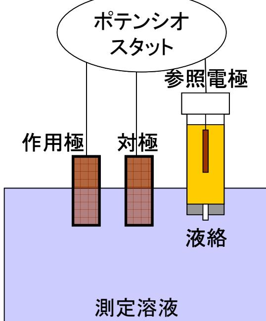
図 1:3 電極による硫化物測定
