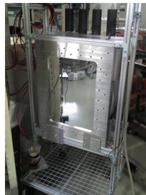
このドリフトチェンバーは元々、真空中に引き出された不安定核のベータ崩壊を観測する際に、電子線の放出方向を特定する為に設計・製作されたものであったが、本研究を開始するにあたり、その入射窓部分の一方に金属薄膜を貼り付ける事で Mott 散乱を起こさせ、その V 字飛跡を計測するという目的の為にデータ収集システム及び解析系を一から構築しなおした。
