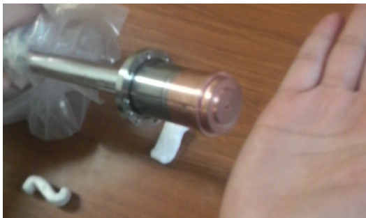
図8 開発した熱陰極付き小型同軸空洞: 既設の熱陰極に代えて4.5空洞高周波電子銃に設置して、三極管型高周波電子銃を構成する。
