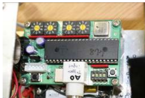
図2 開発した小型タイミングジェネレーター。
