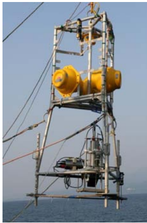
図4 ランダーシステムに搭載した二次元酸素オプトードシステム
