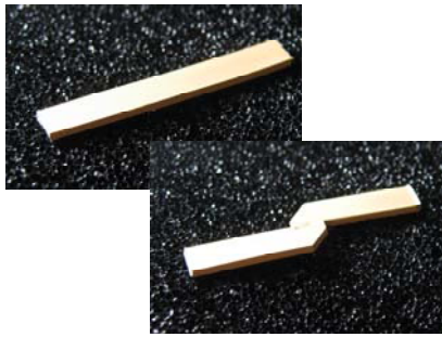
図9 完成した直線導波管とベンド導波管
