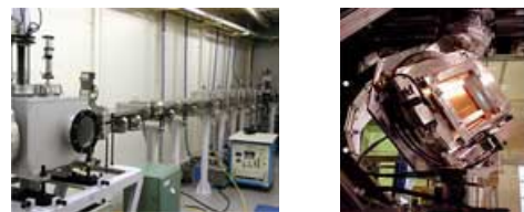
(a) 差動排気機構 (b) 多軸露光装置
