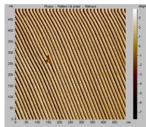
図8. バナナ分子の作るカラムナー相のAFM像。層が柱状に閉じた20nm間隔の組織が見事に観測される
