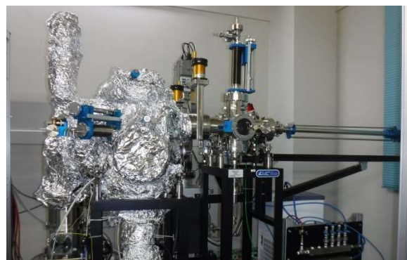
図2：斜め蒸着機構と酸化室（ロードロック室）付き真空蒸着装置の写真
