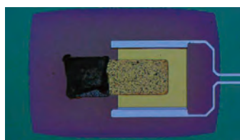
Figure 4: 製作したマイクロカロリメータ素子の光学顕微鏡写真。Ti/Au TES の上下端に接続し、右側に引き出されているのは TES 信号読み出すための電極と配線である。これは Figure 3 では省略されている。
