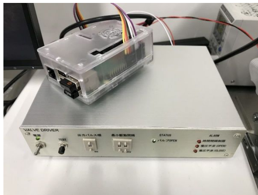
図2: バルブの制御系。駆動回路(下段)を、Raspberry Pi(上段)上のプログラムで制御する。
