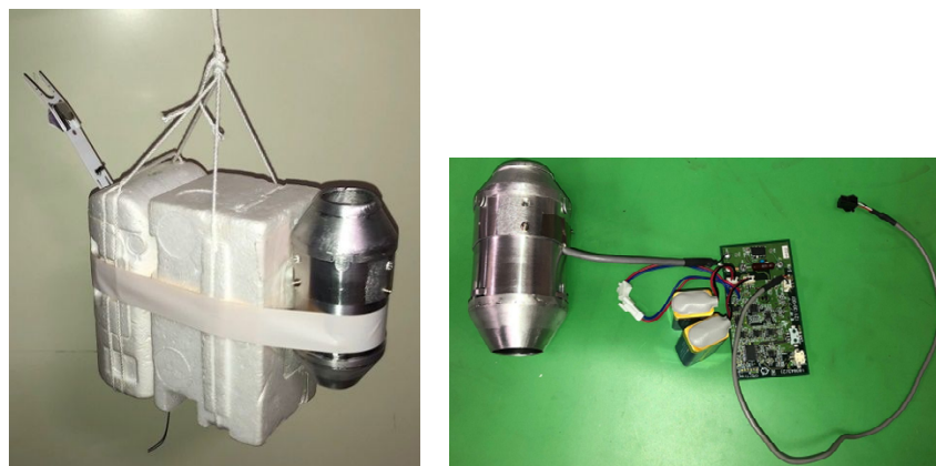
図5．開発された新型電荷ゾンデ．左はGPSラジオゾンデを取りつけた状態，右は誘電リングを内蔵したセンサー部と制御基板および電池
