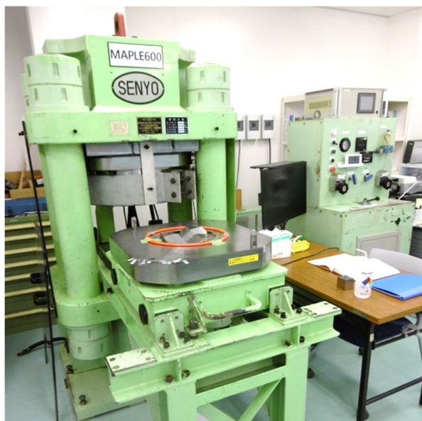
図3。川井式マルチアンビル型高温高圧発生装置（広島大学理学部K棟K103号室）。左：油圧プレス（最大プレス荷重700トン重）と川井式マルチアンビル型ガイドブロック。右：油圧発生-制御装置。右奥：高精度加熱制御-測温システム。2020年度には、この装置を用いることにより、23GPa・1800℃までの高温高圧下においてリングウッドイト・ウォズリアイトなどのマントル遷移層鉱物の多結晶体を合成することが可能になった。
