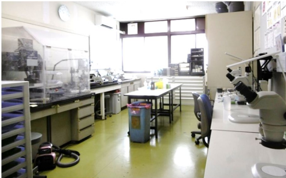
図 1。超高压高温変形実験用の精密加工設備（広島大学理学部 A 棟 A717 号室）。左から、精密 3 次元加工機、精密穴あけ機、精密切断機 2 台、作業台、デジタルマイクロメーター 3 台、厚さ調整治具・箔カプセル製作治具などを収納している工具管理ユニット 2 台、デシケーター、ドラフトチャンパー 2 台、実体顕微鏡 3 台、実体顕微鏡用カメラシステム。別室には、レーザー加工機、精密溶接機、ハンドプレス、小型電気炉などを設置した。
