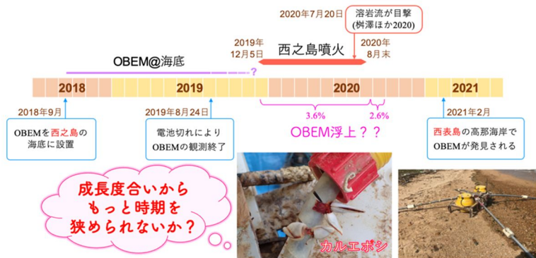
図3. NS15に設置していたOBEMの年表および回収時の写真。
