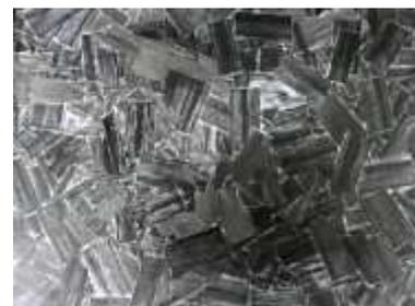
写真3 短 CF ランダム配向積層板
