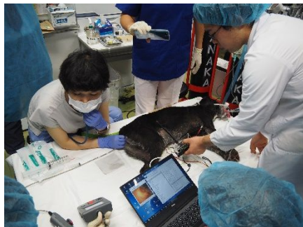
図5 イヌの腸内を走行するカプセルからカメラ画像を伝送する実験
