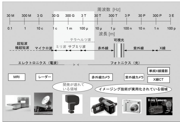
図1 電磁波スペクトルとイメージング技術
