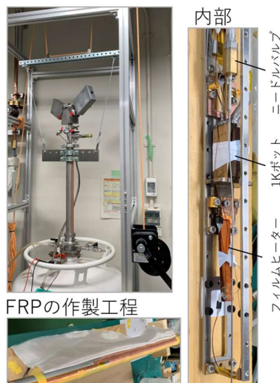
図 5: クライオスタットの外観。右は内部の構造、下は超伝導マグネットの電流供給ラインの作製工程である。
