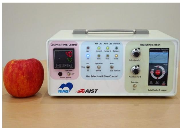
図4 ポータブルなエチレンセンサ試作機
