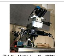
図 1 Dual SPM レーザー振動計
