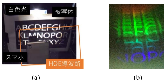
図4 (a) スマートフォン内蔵カメラによる撮影実験の様子。(b)撮影画像。ディスプレイによる影響を受けずに画像の撮影ができています。
