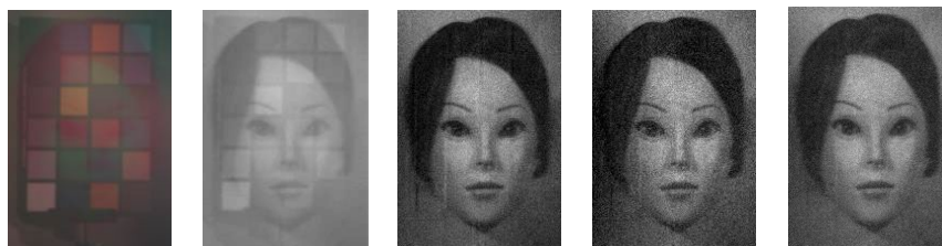
図 6 不要光成分除去の処理結果。(a)不要光成分が混入したカラー画像、(b)vHOE 回折像が強く含まれる 13 バンド目の画像、(c)16 バンド撮影からの処理結果、(d)2 バンド撮影からの処理結果、(e)16 バンド撮影でモザイクフィルタを考慮した手法による推定結果。
