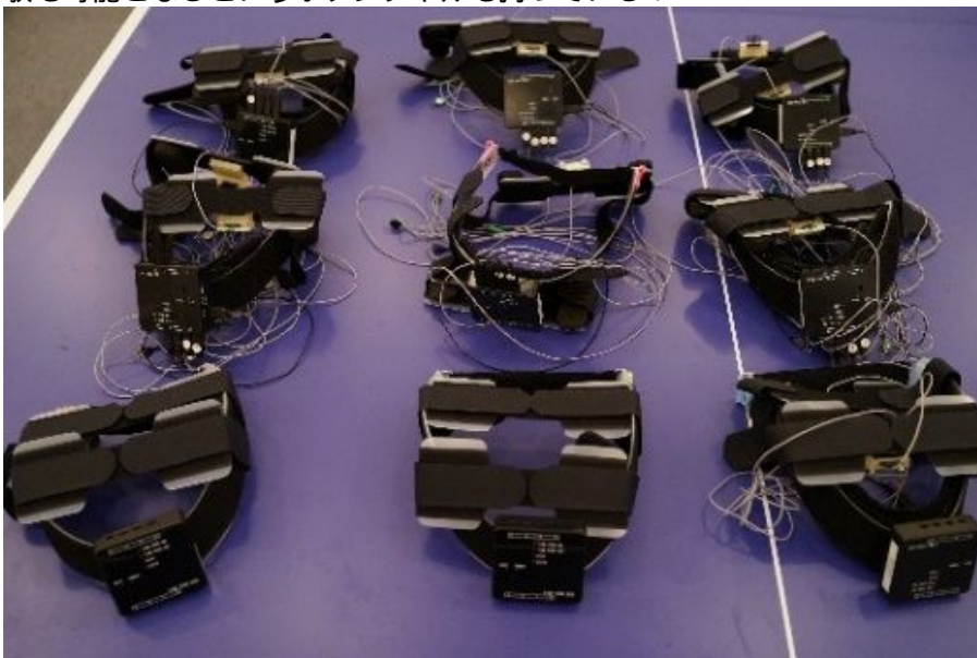
図 1 開発に成功したワイヤレス時刻同期ウェアラブル脳波計
