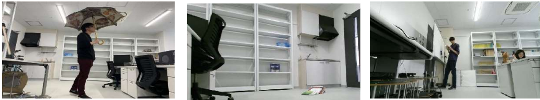
図3 自律移動ロボットで撮影したデータの画像例. 左画像と中央画像は異常領域（室内で傘をさす男性, 床に落ちた本）を含むが, 右画像は含まない.
