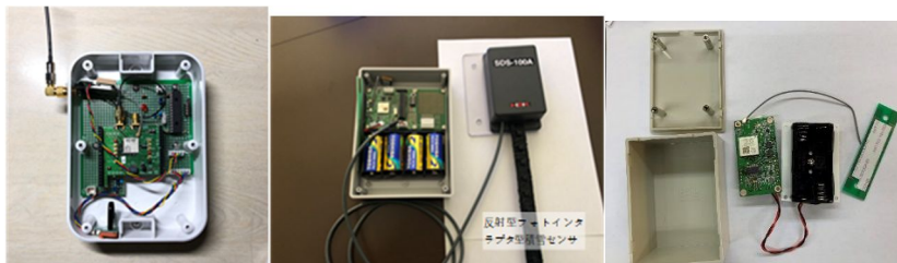
図6 実験受信システム用に試作開発した移動体用送信ノード端末、定点観測用送信ノード端末と積雪計用、商用サービス用に新たに開発した小型汎用送信ノード端末
