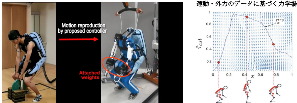
図5 人の運動・外力のデータに基づく力学場を用いたロボットによる人動作再現
