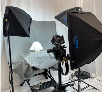
(a)布地ドレープ回転速度変化による撮影 (b)布地ドレープ減少角度に対する布地質感評価特性 図5: 布地質感評価語(柔らかい・はりのある)に対する映像撮影方法及び減少角度と評価の関係
