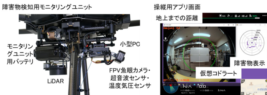
図2 障害物検知用モニタリングユニットとFPVカメラ画像、仮想コドラート、障害物が表示された操縦画面
