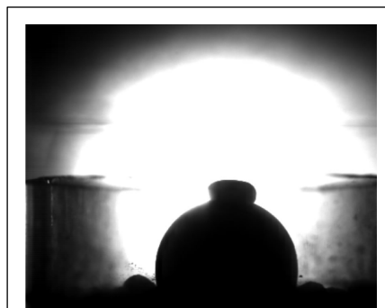
図1：固体球衝突の様子 [Okubo & Katsuragi, (2022)]
