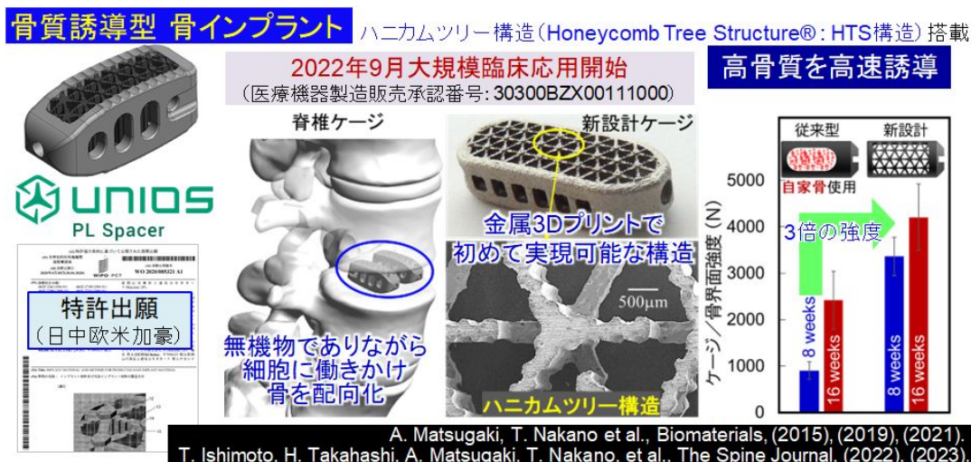
図 3 配向化骨直接誘導のためのハニカムツリー構造 (HTS) を備えた革新的脊椎ケージ。ケージ/骨界面強度は従来型ケージを大きく凌駕する。骨質医療を指向した世界初の医療デバイスである。
