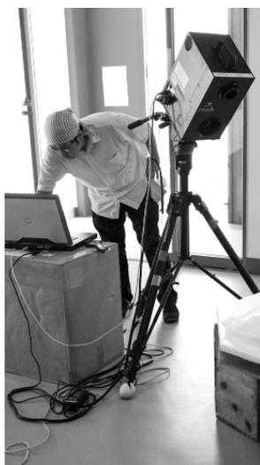
図3 3次元レーザー計測の様子
