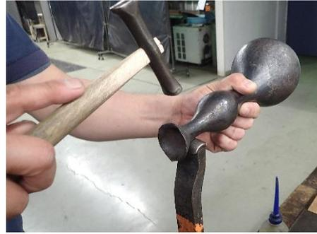
図6. 冷間での打ち出し加工
