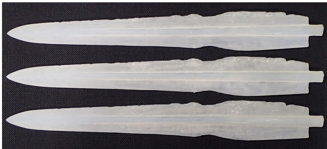
写真 3 神庭荒神谷 B62 号銅剣 3 D デジタルレプリカ研磨実験
