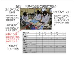
余分な水分を拭き取り、③重量を測定記録したら、④元の紙コップの試験水溶液に戻し浸透開始から 20分後のデータとする。データ処理は、水の浸透による重量変化の割合を求めて解析する。①~④の操作は 30 秒ほど 1 分以内で十分行えるので、10 分間隔の間に 10 サンプルの試験が行えるので実験をそれに合わせて計画する。3 ~ 5 人で組を作り、それぞれの実験目的に合わせた実験スケジュール表(図3)を作成し、操作①~⑤をグループの中で分担を決めておくことが重要なポイントとなる。
